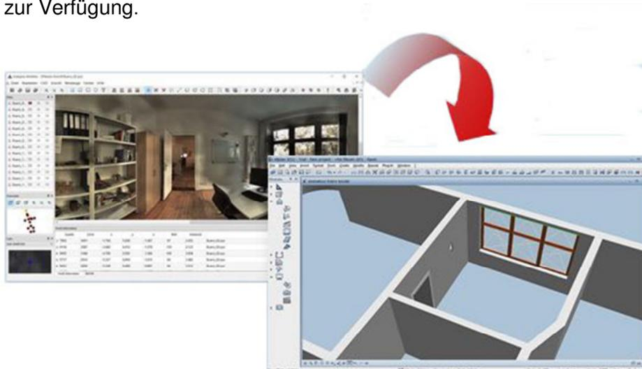
Mit dem **Scalypso ALLPLAN Modeler** rekonstruieren Sie aus einer 3D Punktwolke 3D Elemente und übergeben diese in Echtzeit nach ALLPLAN. Vor der Rekonstruktion der Elemente, werden die Laserscandaten mit dem Scalypso Converter in ein einheitliches Format konvertiert.
